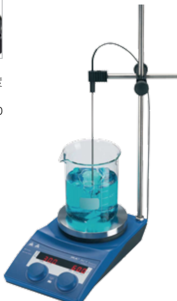
ETS-D5溫度控制器 -50-450°C、解析度 0.1K、精確度±0.2K、PID電子溫控、Pt1000 不鏽鋼探棒
