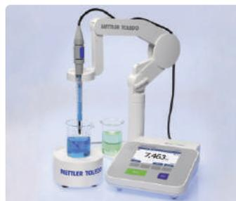
可單手操作且可完全垂直移動的電極支架支援40cm電極使用
